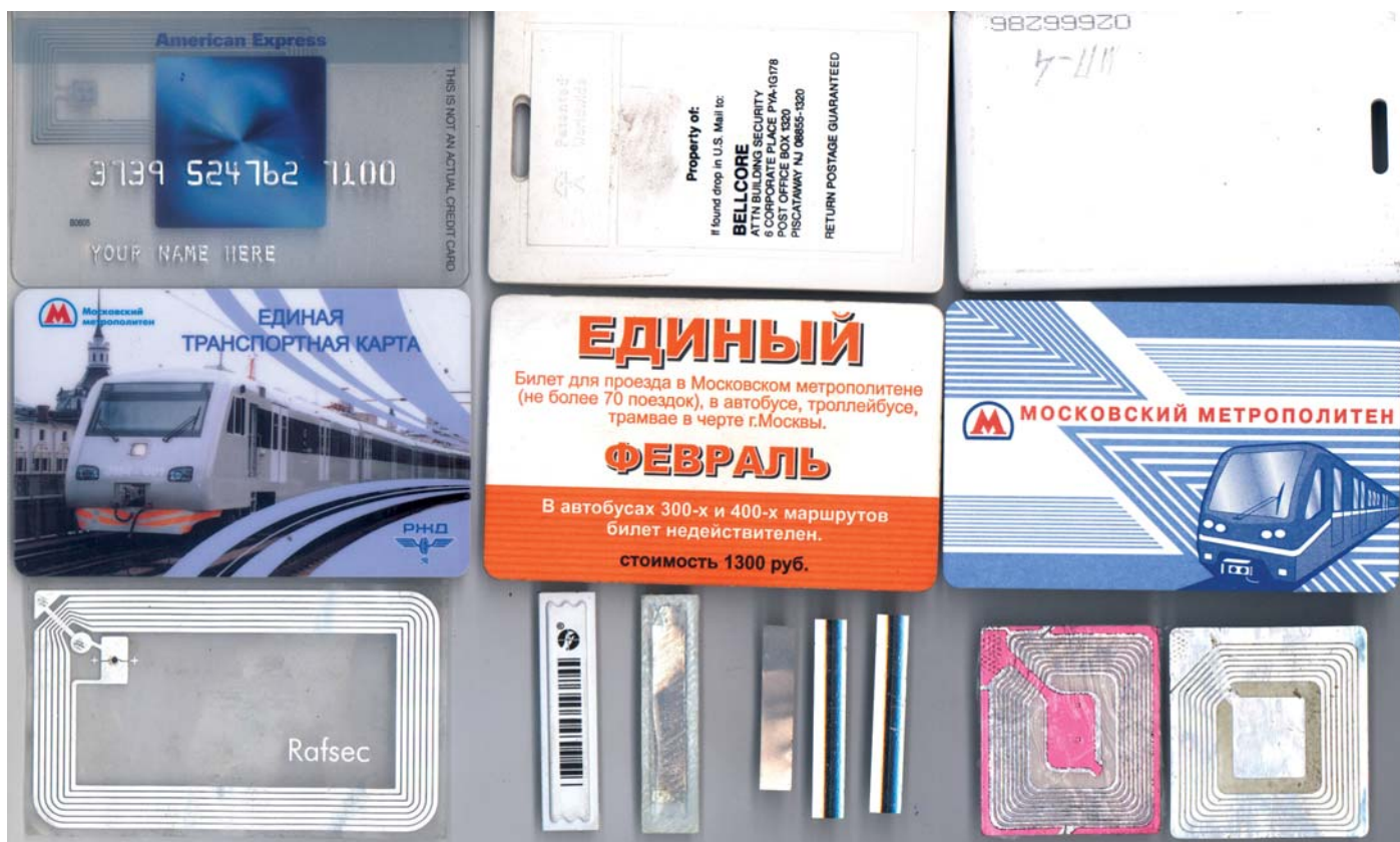
4 Радиометки. Верхний ряд: слева направо – рекламный объект, муляж банковской карты с изображением радиометки, карта для прохода в помещение; средний ряд: проездные билеты; нижний ряд: «начинка» проездного московского метро, намагниченные полоски, контуры, настроенные на определенную частоту, используется электромагнитный сигнал о наличии объекта. В двух последних случаях устройство часто бывает совмещено со штрих-кодом
